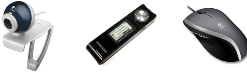
Abbildung 1.2: Beispiele typischer, bekannter USB-Devices. Links: Webcam, liefert Videodaten per USB an den PC; Mitte: MP3-Player, kann per USB mit neuen Musikdateien versorgt werden; Rechts: Maus, ein über USB angeschlossenes Eingabegerät.
