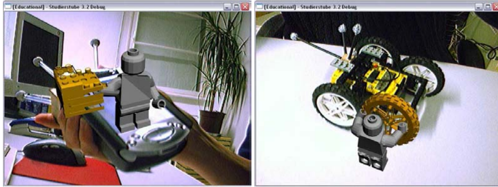
Abbildung 3.4.: ARLego Anwendung. Links : Reparaturagent präsentiert nächstes Bauteil; Rechts : Agent zeigt korrekte Montage des Bauteils
