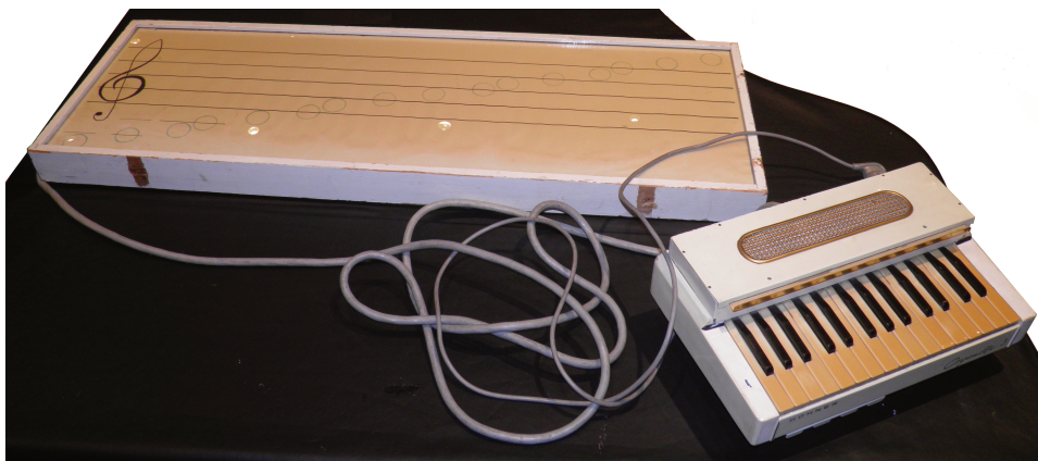
Abbildung 1: Lichtorgel bestehend aus einem Anzeigeelement und einer Klaviatur
