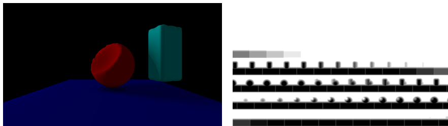
(a) Ergebnis des Voxeltracings mit weichen Schatten und Ambient Occlusion (b) Anordnung der Voxeldaten in der 2D Textur
