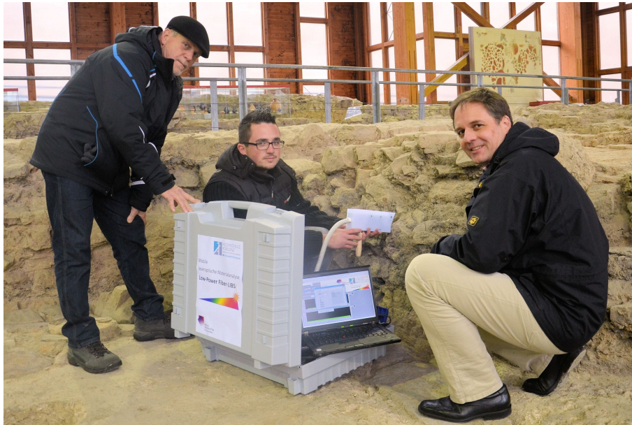
Abb. 4.43: Privates Foto des mobilen Messeinsatzes innerhalb des Museums Roemervilla in Bad Neuenahr-Ahrweiler. Man kann das Low-Power-Fiber-LIBS-System, das Notebook zur Auswertung/Steuerung und die Handmesssonde erkennen.
