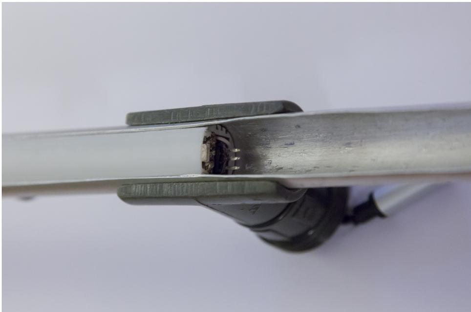
**Abbildung 26:** Steckverbindung der LED's im finalen Zustand
