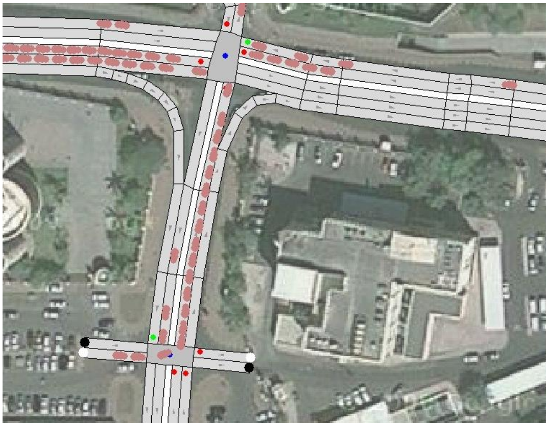
Abbildung 4-41: Staubildung an rote Ampelanlage
