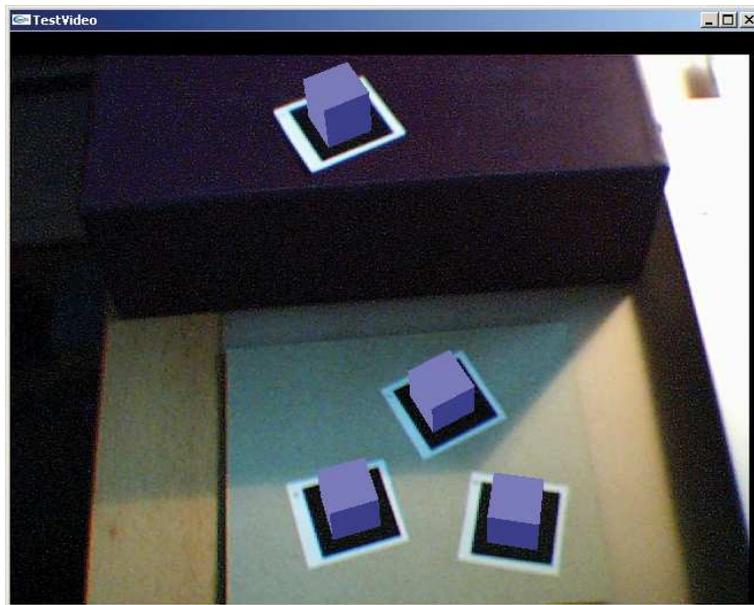
Abbildung 21: Tracking mehrerer Marker auf verschiedenen Ebenen
