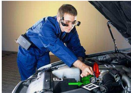
Abbildung 1: Wartung mit Hilfe von AR[7]
