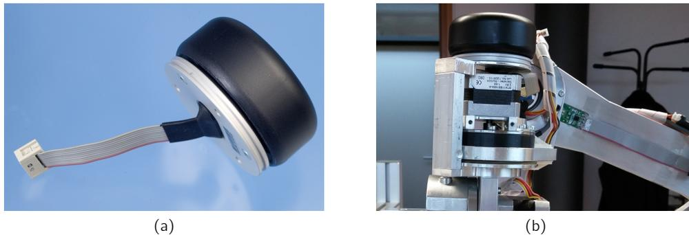
**Abb. 8.28: Industrial Steering Device als Nutzerinterface des Demonstrators.** (a) Ausführung mit UART Kommunikation [226] (b) Ansicht des Manipulators am Demonstrator mit montiertem ISD
