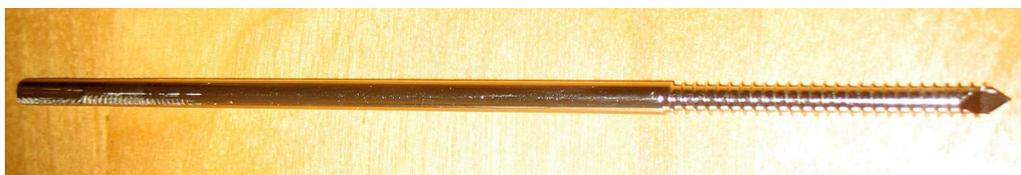
**Abb. A9: Kortikalisschraube.** Für Zugversuche verwendete Schanz'sche Schraube des Typs Aesculap KX378S
