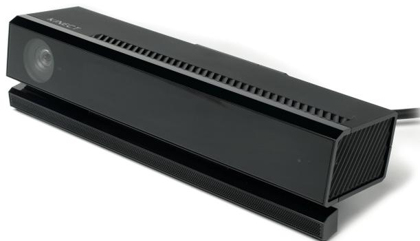
**Abbildung 4:** Microsoft Kinect v2. Dieses Modell wurde auch zur Aufnahme der Testdaten dieser Arbeit verwendet. [11]
