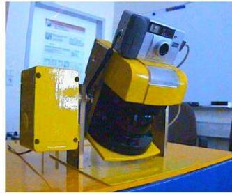
Bild 2.2: AIS 3D Laserscanner, Quelle: [SLNH01]
