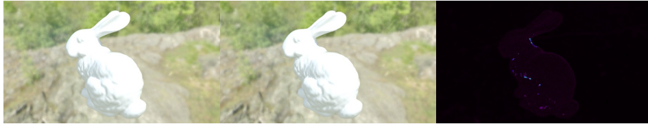
(a) Primärstrahlen und Schatten mit BVH, Indirektionen mit Line Space (b) Primärstrahlen mit BVH, Indirektionen mit Line Space (c) Unterschiede zwischen beiden Methoden
