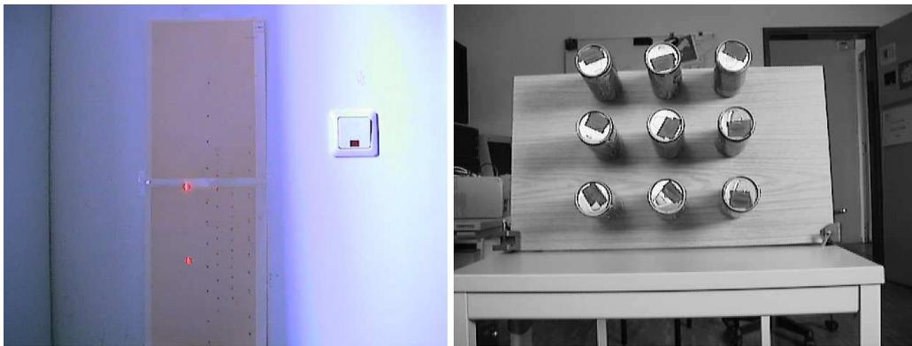
Bild B.2: Links: Manuelle Messung der Servogenauigkeit. Rechts: Kalibrierungsmuster.
