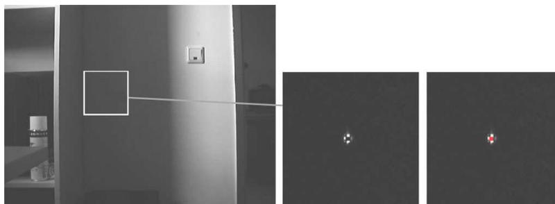
Bild 5.2: Referenzbild mit Bildausschnitt des Differenzbildes und des gefundenen Laserpunktes mit eingezeichnetem Schwerpunkt (v.l.n.r).
