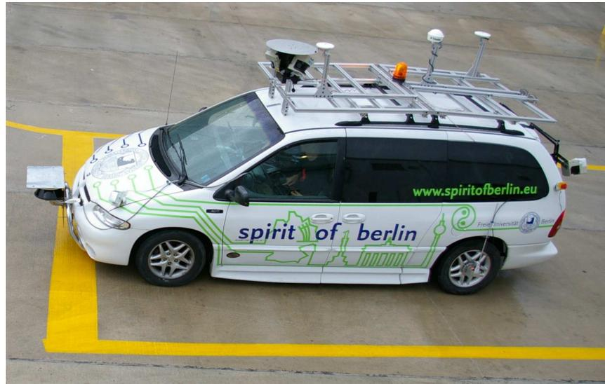
Bild 2.1: “Spirit of Berlin”, ein selbstfahrender Mittelklasse-Wagen. Quelle: [Spi].
