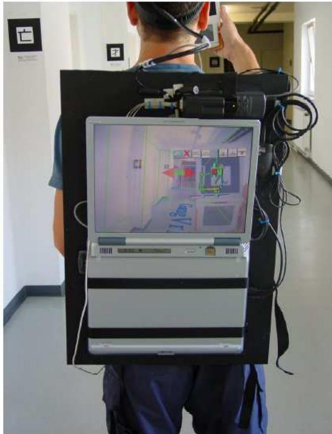
Bild 2.4: Markerbasierte Lokalisation. Quelle: [KLK<sup>+</sup>02].
