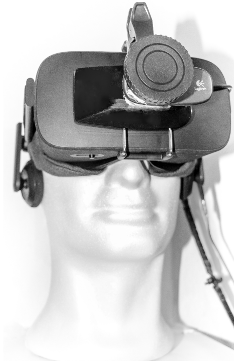
Abbildung 33: Aufbau des hybrides AR-/VR-HMDs
