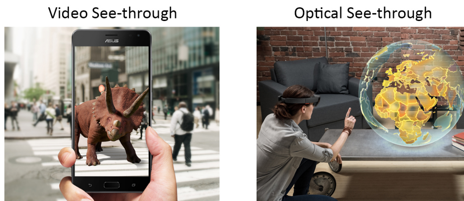
Abbildung 2: AR Video See-through am Beispiel eines Smartphones und Optical See-through am Beispiel einer AR-Brille (Lancaster, Luke, 2016; Fremont, 2017) [Foto]
