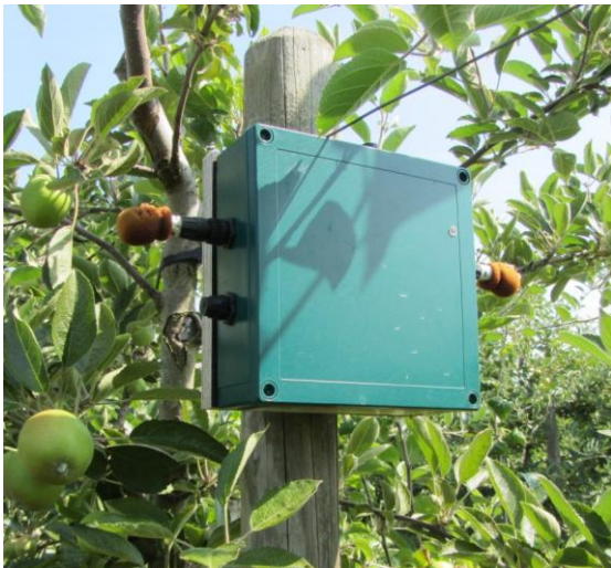
Abbildung 13: Songmeter an einem Pfahl auf der Apfelkontrollfläche
