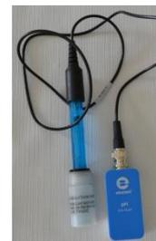
2. Tippe in das obere Feld den Wert „4“ ein. Halte die Elektrode in ein kleines Becherglas mit der Pufferlösung (pH=4 Standard). Wenn sich der Wert stabilisiert hat, logge ihn durch Anklicken des „Schloss“-Symboles ein.
