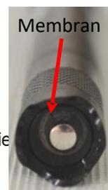
**Anmerkung:** Es dauert eine Weile, bis sich der Wert stabilisiert! Sei geduldig! Die Membran der Elektrode ist sehr empfindlich und grenzt die Elektrodenlösung im Inneren ab. Falls die Membran beschädigt wurde oder Luftblasen sichtbar sind, lasse dir von einer Lehrkraft helfen.
