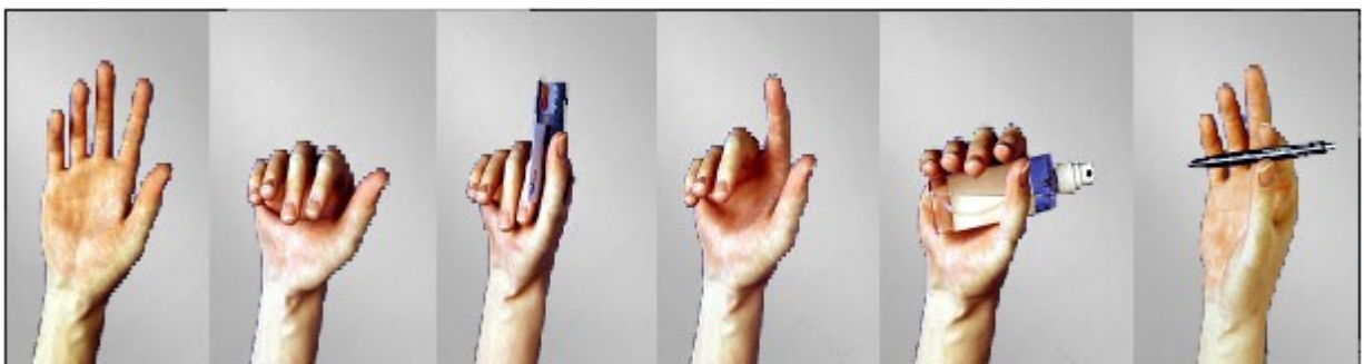
Abbildung 26: Die fünf Griffe der fluidischen Hand (Forschungszentrum Karlsruhe)
