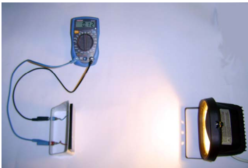
Abb. 4.18: Messung von Kurzschlussstromstärke und Leerlaufspannung einer Solarzelle
