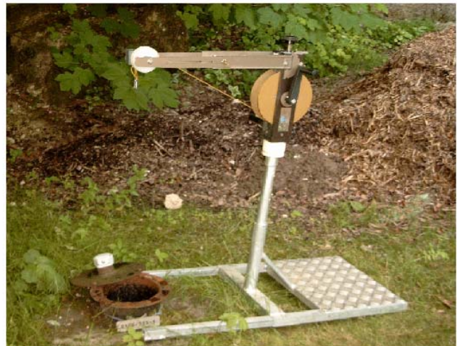
Abb. 8: Für die Probenahme verwendete Seilwinde und Halterungskonstruktionen.
