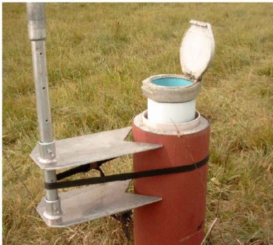
Abb. 8: Für die Probenahme verwendete Seilwinde und Halterungskonstruktionen.
