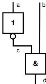
Abbildung 2.1: Beispielschaltkreis mit einem Inverter und einem AND-Gatter
