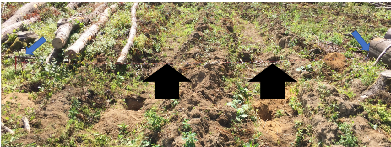
Abbildung 15, Über Transekt 7 gespanntes Maßband, die blauen dünnen Pfeile markieren die Bodennägel, die schwarzen dicken das gespannte Maßband, eigene Aufnahme 2018
