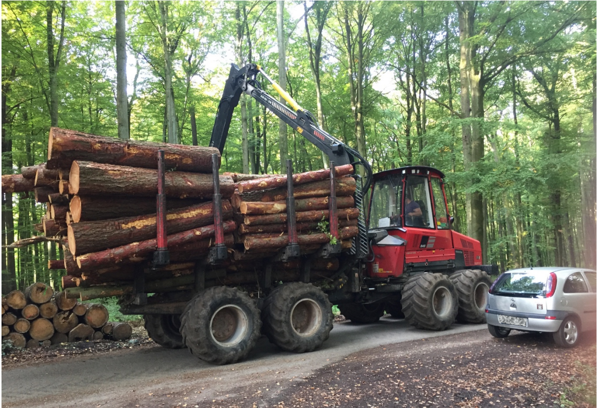
Abbildung 37, Forwarder des Typs Komatsu 845, eigene Aufnahme 2018
