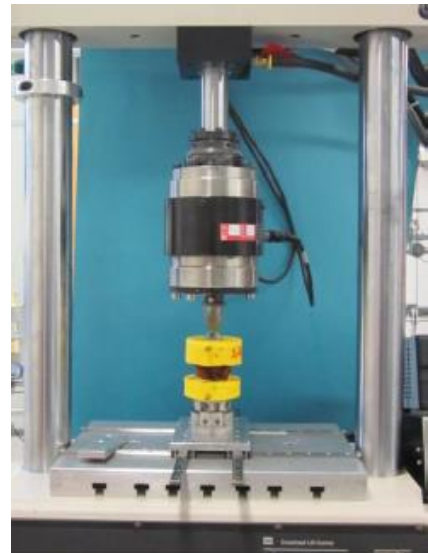
Abbildung 54 - Probe eines Bewegungssegments L2-L3 im Spine-Tester fixiert zur Bestimmung des Kraft-Deformations-Zusammenhangs (Hausen, 2013, 31).
