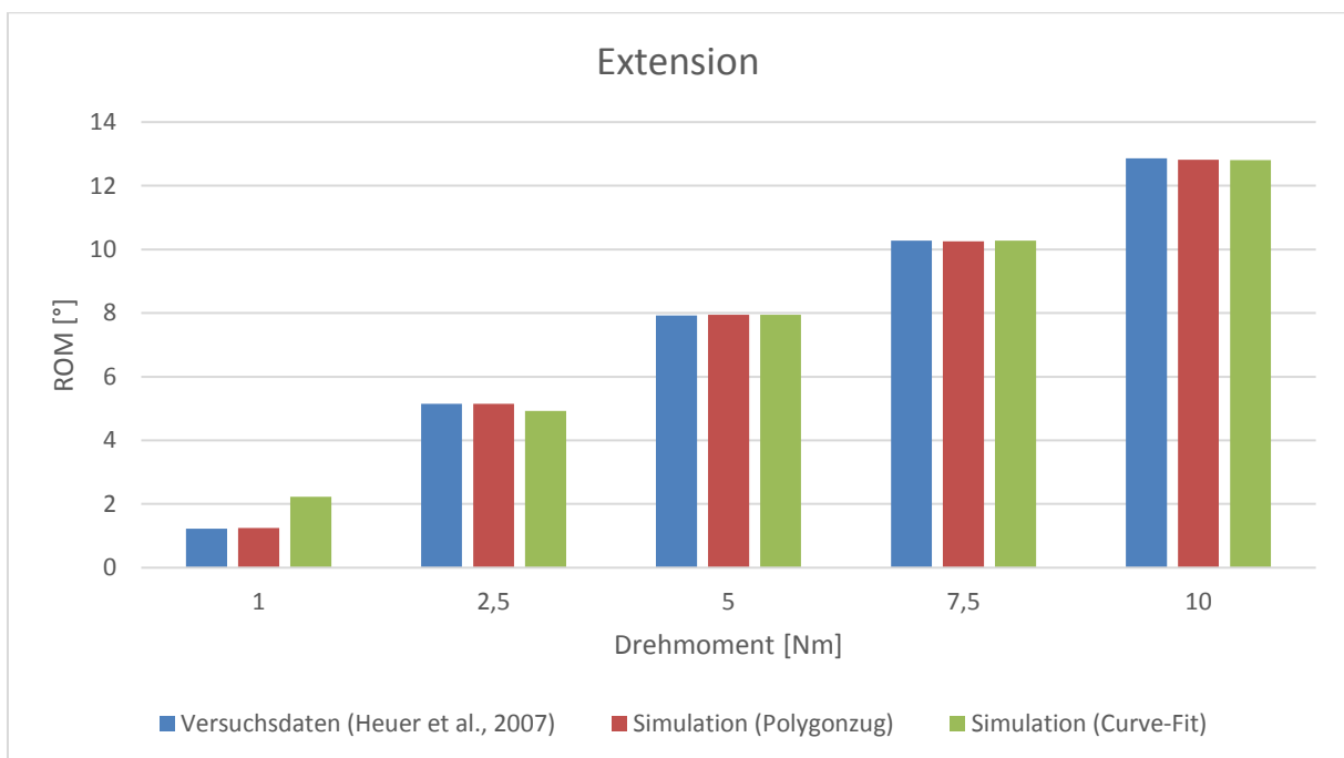
Abbildung 64 - Vergleich der ROM bei aufgebrauchten Drehmomenten bei Extension zwischen den Versuchsdaten von Heuer et al. (2007) und den Simulationen.
