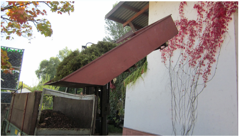
Der Trester wird in einer Wanne aufgefangen und mit einem Stapler direkt in den Kompoststreuwer gekippt.
