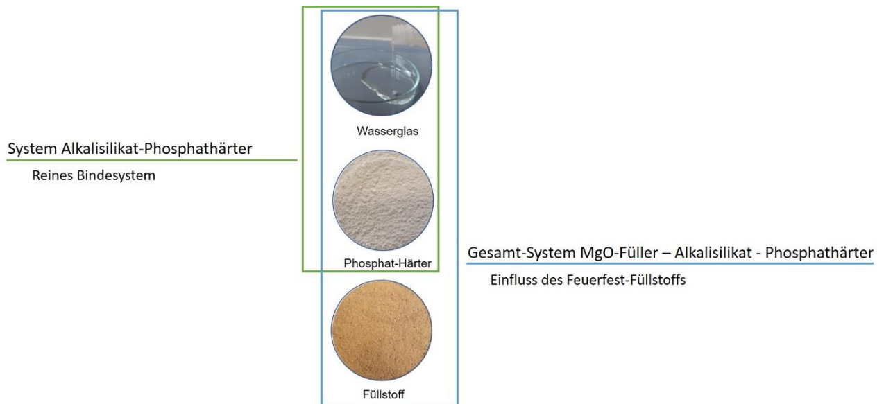
Abb. 19: Zusammensetzung der beiden untersuchten Stoffsysteme
