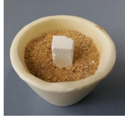
Abb. 26: Probekörper aus reiner Bindephase in Füllstoff-Bett (zur besseren Sichtbarkeit hier noch nicht komplett bedeckt)
