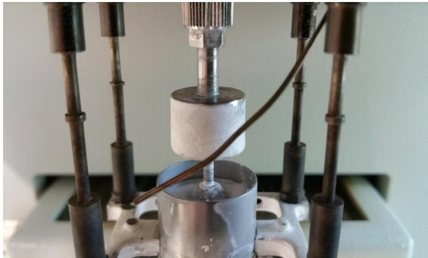
Abb. 23: DMA der reinen Bindephase in einem Tiegel mit kugelförmigen Fühlstempel (Fühlstempel noch nicht eingetaucht)
