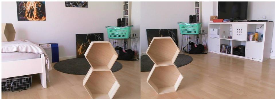
**Abbildung 51:** Holzregal ist zu nah am Kamerasetup und verursacht perspektivisches Problem; links: Bild der mittleren Kamera, rechts: Bild der rechten Kamera
