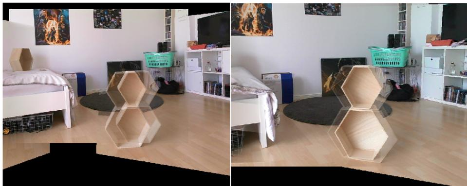
**Abbildung 52:** Blendingfehler durch perspektivisches Problem; links: Blending mit konstanter Gewichtung 0,5; rechts: Blending mit linearer Interpolation
