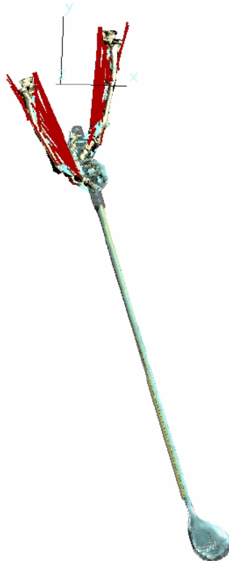
Abbildung 6-35: MKS-Modell der beiden oberen Extremitäten mit modellierten Weichteilstrukturen und Modell des Golfschlägers.
