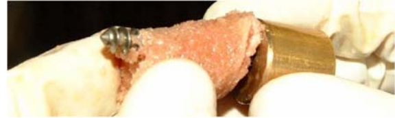
Abbildung 4-37: Versagen des Knochenzylinders während der zweiten Versuchsreihe. Die Richtung der Achse der Knochenschraube und der Längsachsen des Knochenzylinders verliefen nicht parallel, daher kam es zum Bruch des Knochenzylinders an der Austrittsstelle der Schraube.
