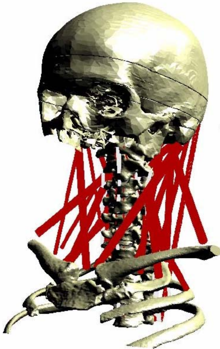
Abbildung 5-2: MKS-Modell Kopf-Nacken mit modellierten Knochen, passiven Weichteilstrukturen (Bänder, Zwischenwirbelscheiben) und Muskelementen.
