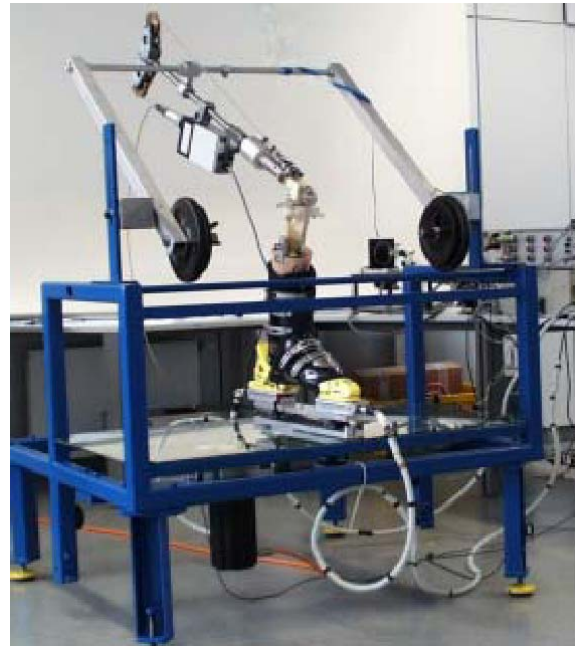
Abbildung 4-27: Aufbau des Prüfstands zur Ermittlung der Belastungen im Kniegelenk unter verschiedenen Flexionsstellungen [246].
