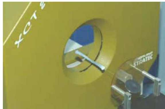
Abbildung 3-7: Ermittlung des Sehnedurchmessers im pQCT-System XCT2000 (Fa. Stratec).
