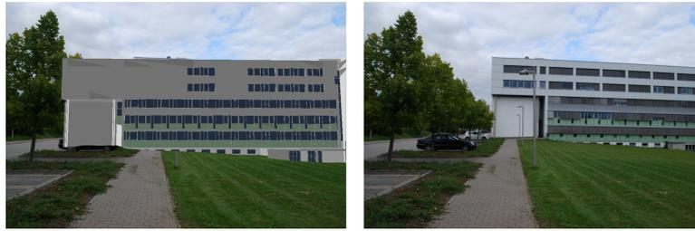
**Abbildung 20:** Unzureichender Detailgrad in der Modellierung führt zu schlechterem Matching der Poseverfeinerung.
