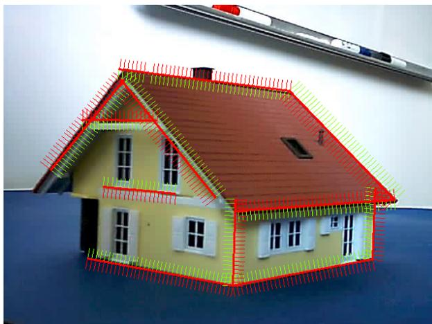
**Abbildung 56:** Beispiel des Matchings mit orthogonalen Suchlinien.
