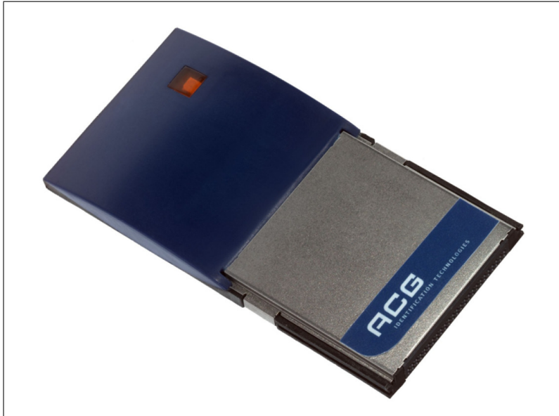
Abbildung 9.2: RFID-Leser als Erweiterungskarte mit CF-Schnittstelle [ACG 2003].
