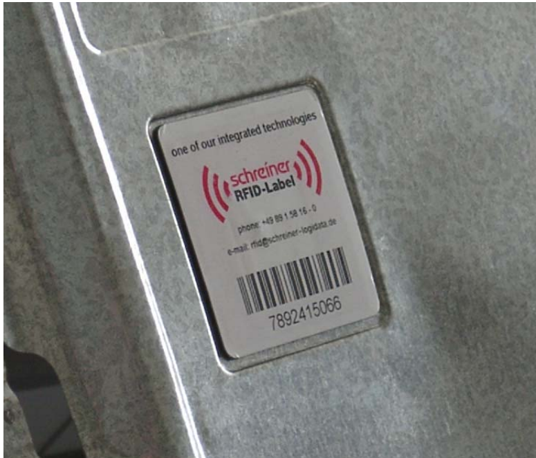
Abbildung 9.1: Mount-on-Metal -Tag versenkt in ein Blech eines Containers.
