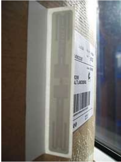
Abbildung 2.7: Angebrachter FlagTag senkrecht zur Oberfläche [SATO Flag-Tag 2006].
