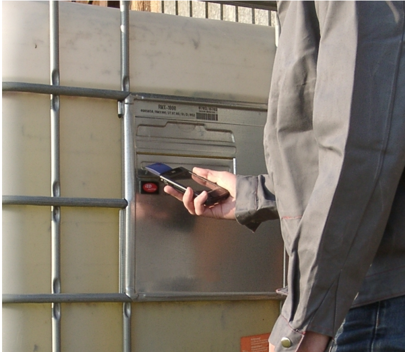
Abbildung 9.3: Einsatz eines PDA zur Erfassung von RFID-Daten eines Containers.
