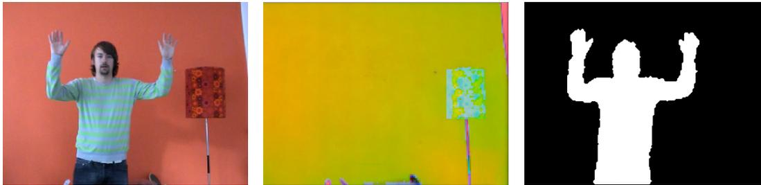
(a) Aktueller Frame der Kamera. (b) Visualisierung des Hintergrundmodells im HSV-Farbraum. (c) Berechneter binärer Vordergrund.
