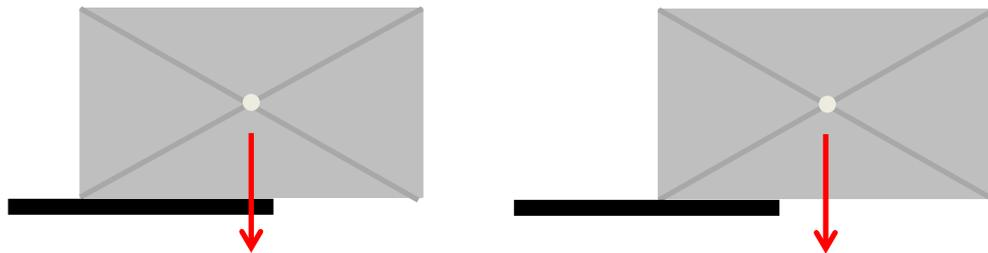
Abb. 3.1: Gleichgewichtslagen eines Objekts: stabil (Situation 1) und instabil (Situation 2)
