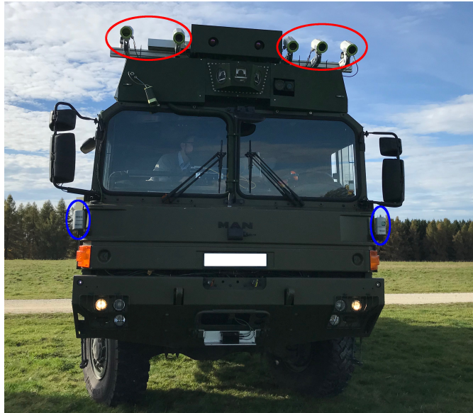
Abbildung 15: Fahrzeug mit Kameras (rot hervorgehoben) und zwei 3D-Laserscannern (blau hervorgehoben)
