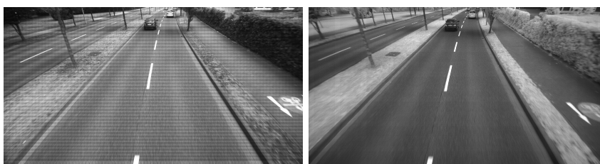
(a) Beispiel für Rohbilddaten, die von der VIS-Kamera aufgenommen wurden (b) Beispiel für Rohbilddaten, die von der NIR-Kamera aufgenommen wurden
