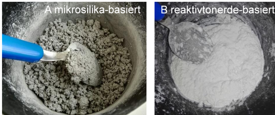
Abbildung 43: Makroskopisches Erscheinungsbild der zement-freien Feuerbetone bei \text{pH} = 12 nach \text{CaCl}_2 -Zugabe, (A) mikrosilika-basiert bei C_{\text{CaCl}_2} = 100 \text{ mg/cm}^3 , (B) reaktivtonerde-basiert bei C_{\text{CaCl}_2} = 200 \text{ mg/cm}^3 .
