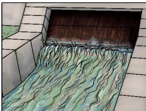
Rechen im Klärwerk
