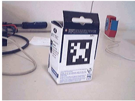
Bild 3.6: Kameraaufnahme einer Innenszene mit ARToolkitPlus Marker.
