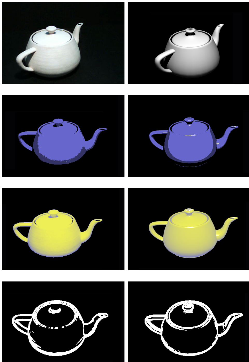
Abbildung 12: Stilisierung, Kamerabild (links) und gerendertes Bild (rechts). Von oben nach unten: Diffuses Shading mit Selbstverschattung, Toon Shading, Gooch Shading, Kantenbilder.
