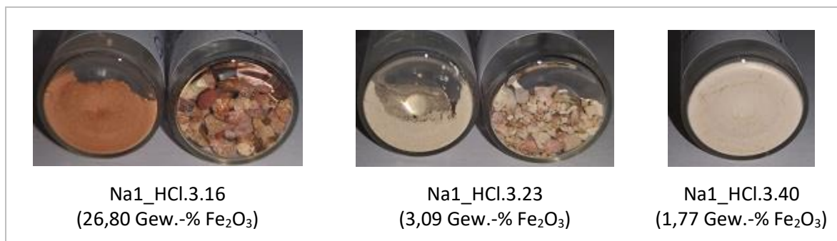
Abbildung 36: Optisches Erscheinungsbild von Na1_HCl.3.16, Na1_HCl.3.23 und Na1_HCl.3.40 nach Laugung
