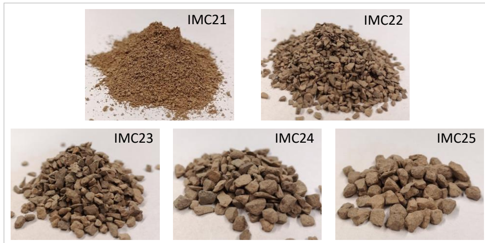
Abbildung 32: Kornfraktionen von Bauxit IMC2 (IMC21, IMC22, IMC23, IMC24 und IMC25)
