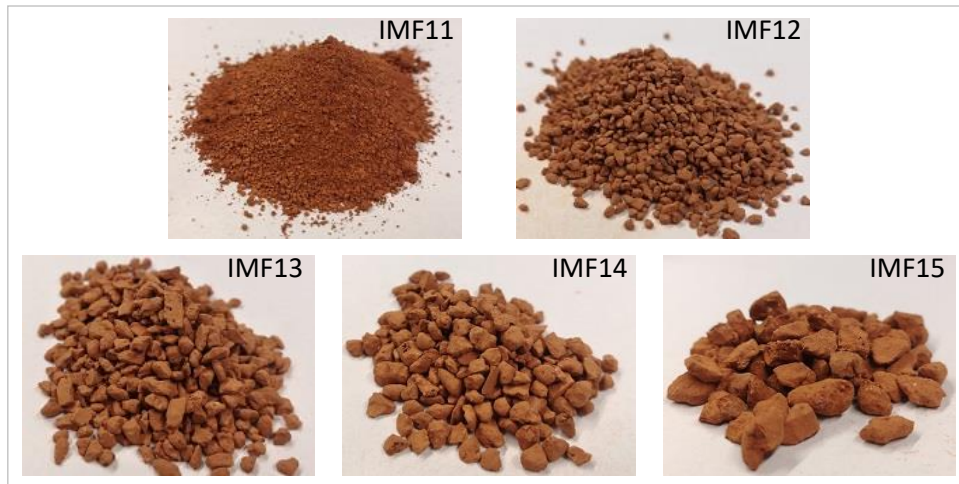
Abbildung 29: Kornfraktionen von Bauxit IMF1 (IMF11, IMF12, IMF13, IMF14 und IMF15)
