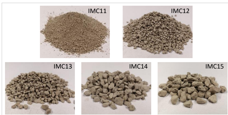
Abbildung 30: Kornfraktionen von Bauxit IMC1 (IMC11, IMC12, IMC13, IMC14 und IMC15)
