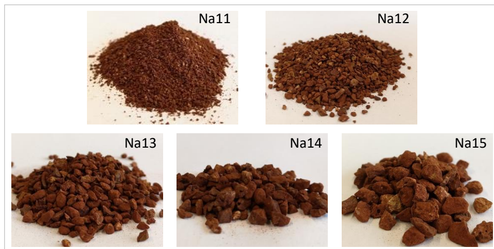
Abbildung 28: Kornfraktionen von Bauxit Na1 (Na11, Na12, Na13, Na14 und Na15)
