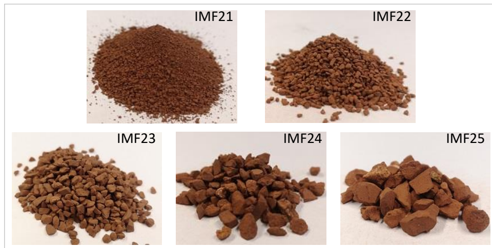
Abbildung 31: Kornfraktionen von Bauxit IMF2 (IMF21, IMF22, IMF23, IMF24 und IMF25)
