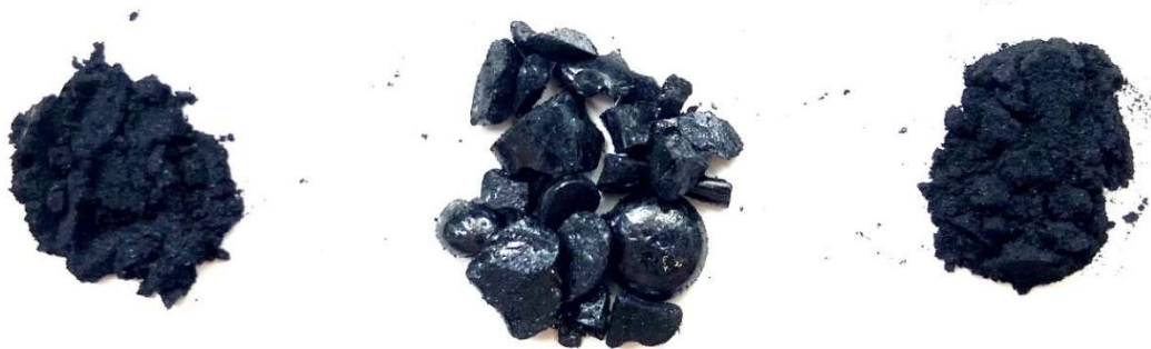
Abbildung 9: Rohzustand der untersuchten Bindemittel CTP1, CTP2 und CTP3 (v.l.n.r)
