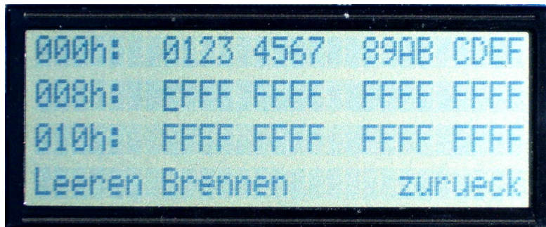
Abbildung 10: Die Editoransicht. In der linken Spalte wird die Adresse des jeweils ersten Bytes der Zeile hexadezimal angezeigt, es folgen 8 Byte Daten. Der Cursor steht im Bild an der Adresse 008h. In der untersten Zeile sind die aktuellen Belegungen der Softkeys 1, 2 und 4 angegeben.
