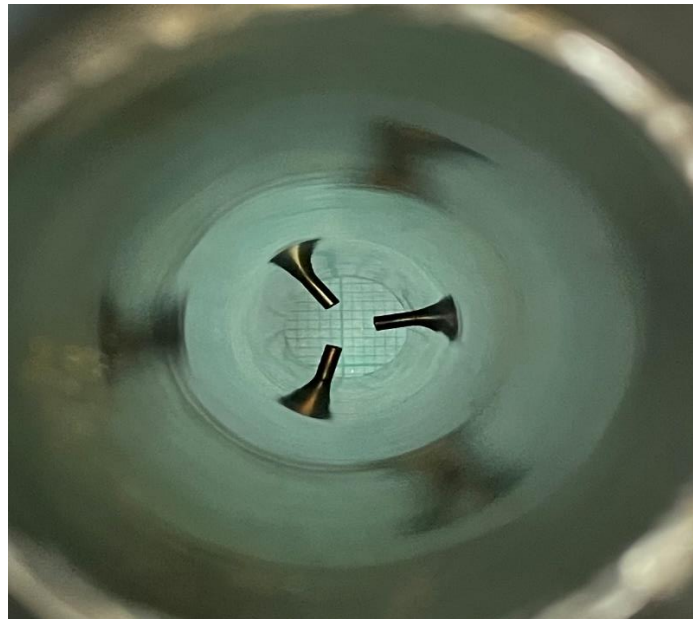
Abbildung 24: Innenansicht des Reaktors von oben, Blick auf die Auflager für die Positionierung der Proben
