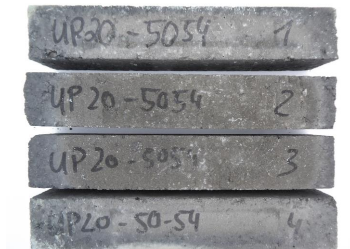
Abbildung 20: Inhomogenes Bild von vier identischen Materialien nach Auslagerung im Muffelofen bei T = 1400 °C für t = 200 h. Die helle Verfärbung variiert stark in Abhängigkeit der Ofenposition
