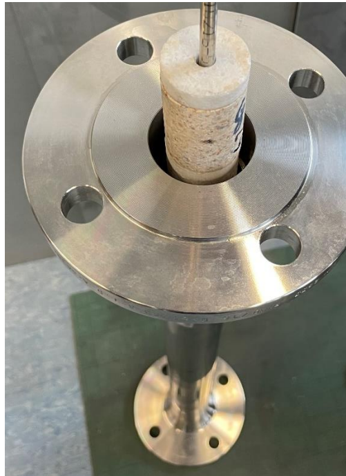
Abbildung 28: Einführung des Probesturms mit Transporthilfe in den ausgebauten Reaktor
