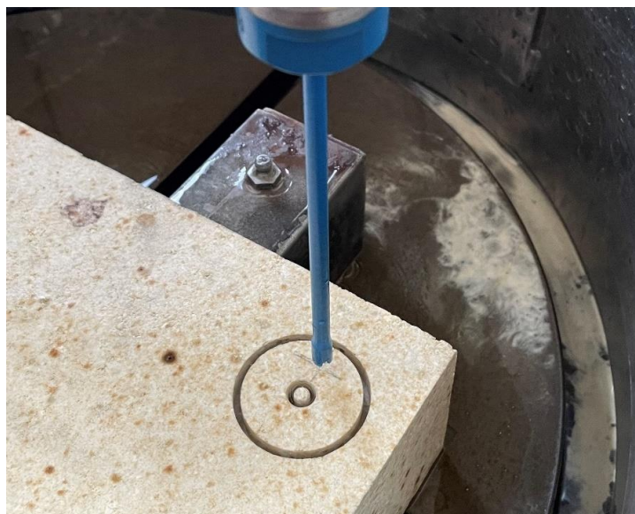
Abbildung 30: Nassbohren der Prüfkörper, nach dem Bohren von Zylinder und Kanal wird der Fixierungskanal gesetzt
