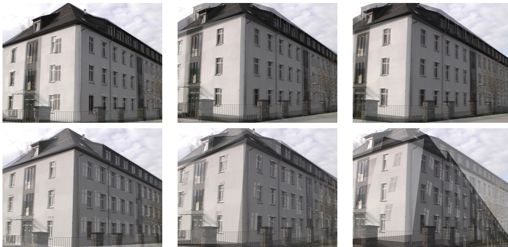
Abbildung 4.18: Beispielbilder, in denen das Modell mit der jeweils berechneten Pose über das Videobild gelegt wurde. Die obere Reihe ist mit dem Förstner-Operator (NCC mit RANSAC, mit Textur, Beleuchtung und interpolierten Normalen) und die untere Reihe mit dem SUSAN-Detector (NCC mit RANSAC, ohne Textur, mit Beleuchtung und interpolierten Normalen) berechnet worden. Die jeweils linken Bilder stammen vom Beginn der Sequenz, die mittleren von der Mitte und die rechten vom Ende.
