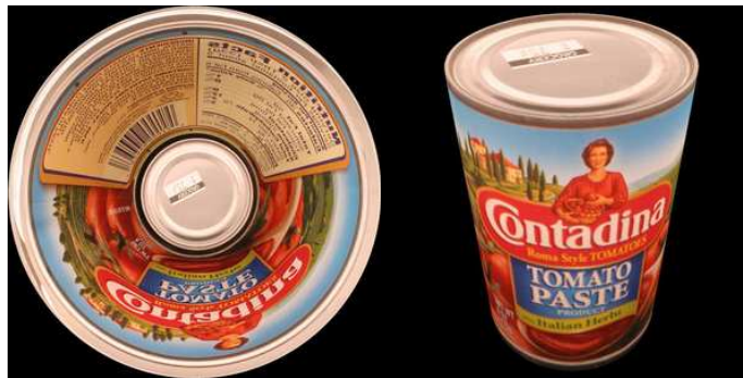
Bild 3.25: Erfassen der vollständigen Textur eines konvexen Objektes (aus [KN06]). links: Rohaufnahme des Objektes im Spiegel. rechts: 3D-Modell mit der gewonnenen Textur.
