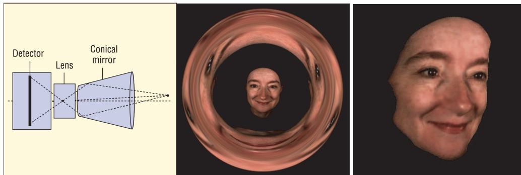
Bild 3.4: links: Schema eines radialen Stereosystems, mitte: Rohaufnahme dieses Systems rechts: texturiertes 3D-Modell (aus [Nay06])
