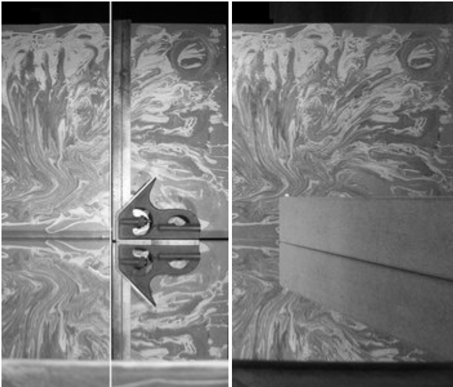
Bild 4.1: links: Ausrichten der Scanlinien an der Spiegelebene (senkrechte weiße Linie zur Orientierung), rechts: „Zielvorrichtung“ zur Ausrichtung der optischen Achse.
