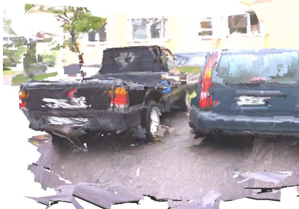
Bild 2.4: Rekonstruktion von Nistér. Modell wurde aus mehreren Ansichten erstellt. (Abbildung aus [NS01])
