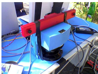
Abbildung 6.3: Foto des Versuchsaufbaus (links) und Produktabbildung des Lasermesssystems SICK LMS 200 (rechts).
