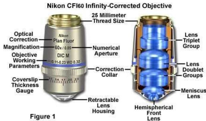
Abbildung 2.5: Querschnitt eines Nikon 60-fach Objektivs, aufgebaut durch mehrere Linsen innerhalb des Objektivs Quelle:[Mic09b]
