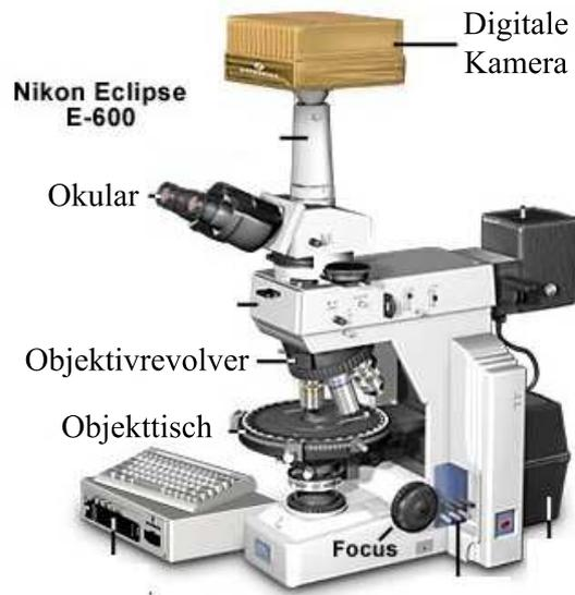
**Abbildung 2.1:** Aufbau eines Durchlichtmikroskops, Quelle: [Mic09a]
