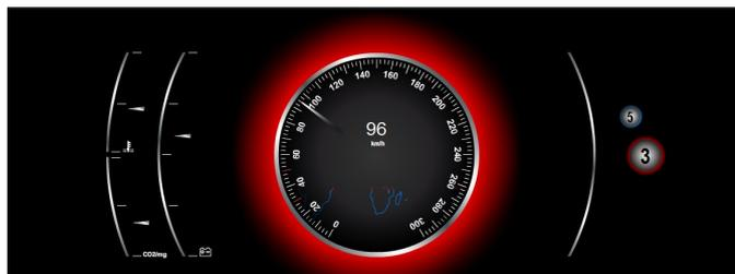
**Abbildung 52:** Ganganzeige bei ineffizienter Fahrweise
