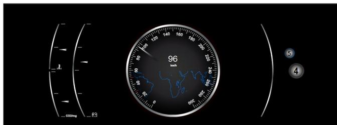
**Abbildung 51:** Ganganzeige bei neutraler Fahrweise
