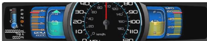
Abbildung 26: Ford Smart Gauge im Zustand Enlighten
