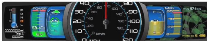
Abbildung 27: Ford Smart Gauge im Zustand Engage
