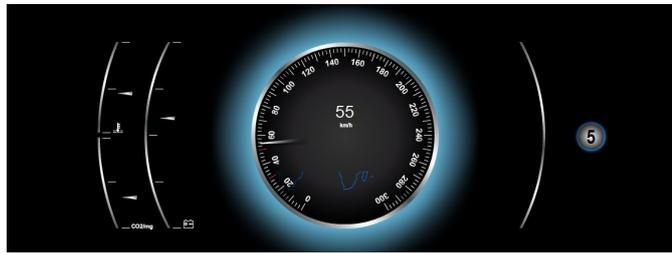
**Abbildung 50:** Ganganzeige bei effizienter Fahrweise
