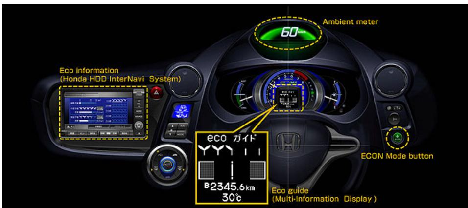
Abbildung 30: Eco-Driving System des den Honda Insight Hybrid
