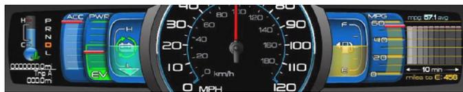
Abbildung 28: Ford Smart Gauge im Zustand Empower
