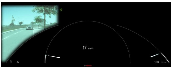
Abbildung 41: TW-Assistent mit Seitenspiegelkamera, volle Anzeige
