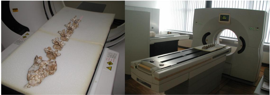
**Abb. 4.7 Philips Secura CT:** Einscannen der einzelnen Wirbel mit einer Schichtdicke von 1mm zur Generierung der Wirbeloberflächen für das Modell der lumbalen Wirbelsäule.
