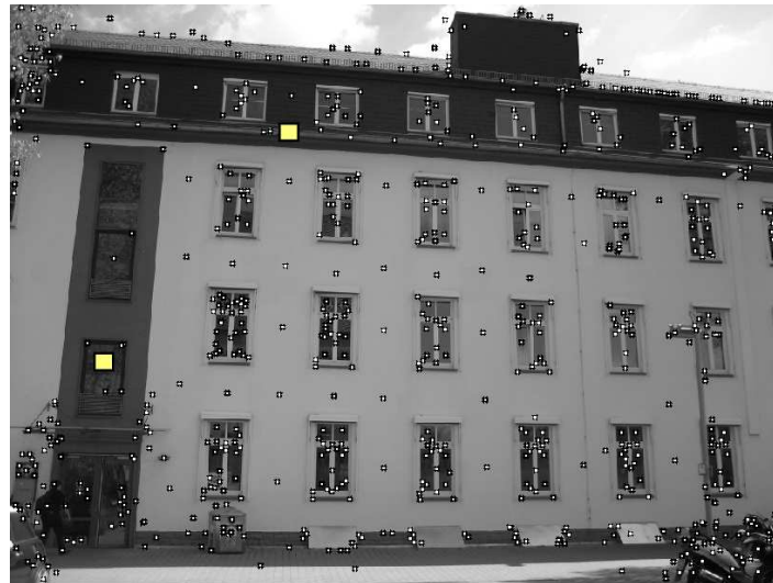
Abbildung 9: Zwei Merkmale mit unterschiedlicher Semantik aber ähnlichem 128-dimensionalen Merkmalsvektor
