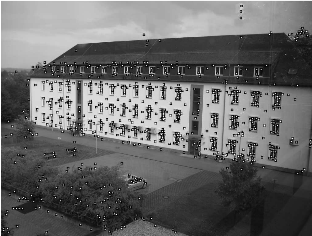
Abbildung 7: Markante Bildpositionen aus SIFT
