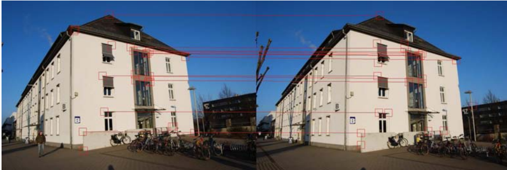
Abbildung 30: Positionen an denen markante Eckpunkte gefunden wurden und die auf SURF-Deskriptoren basierenden Korrelationen.
