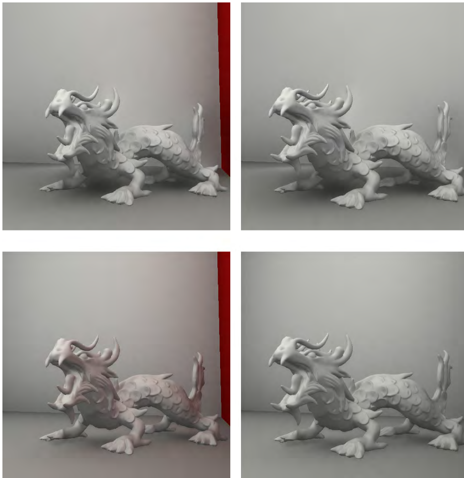
Abbildung 29: Grenzfallbetrachtung: Oben SSGI, unten Hybrid-GI. Links ist die rote Wand noch knapp im Bild zu sehen und wirft daher indirektes rotes Licht auf die hintere Wand und den Drachen. Der Effekt auf dem Drachen ist nur bei Hybrid-GI deutlich zu erkennen. Warum SSGI hier den Color Bleeding-Effekt kaum zeigt, wird auf S. 46 erläutert. Rechts ist die rote Wand aus dem Bild verschwunden, sodass sie kein indirektes rotes Licht mehr reflektieren kann.
