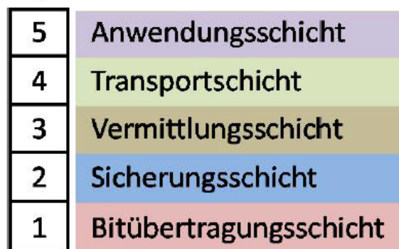
Abbildung 2.15: Modifiziertes Hybridmodell eines OSI-Schichtenreferenz-Modells
