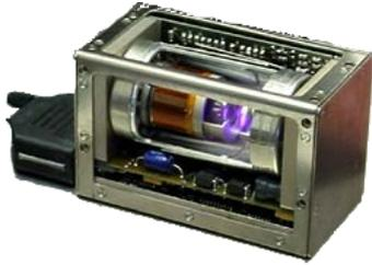
Abbildung 2.9: Atomuhr eines GPS-Satelliten
